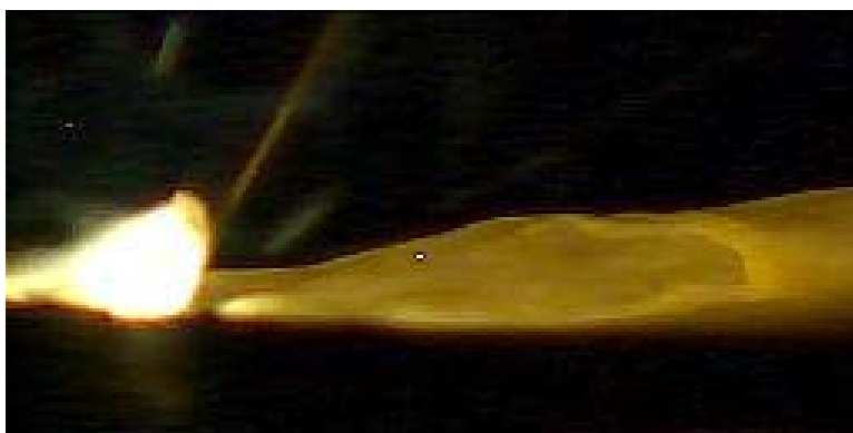
図10 長時間溶接におけるビード外観
