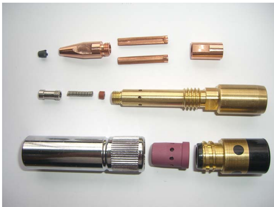
図4 開発した溶接トーチの模式図（上）および 構成部品（下）
