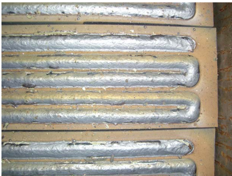
図10 長時間溶接におけるビード外観
